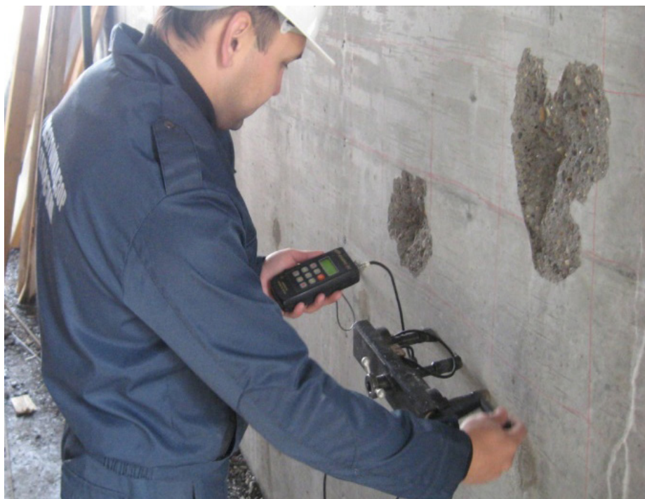
Испытание бетона методом отрыва со скалыванием
